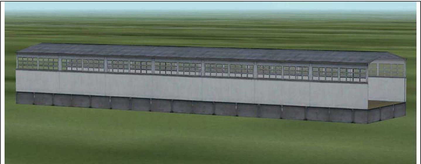
**Überdachtes Brückenteil OK\_IV\_Bruecke\_N1\_AF1, 48 m lang; schließt sich an den nördlichen Treppenturm an**
