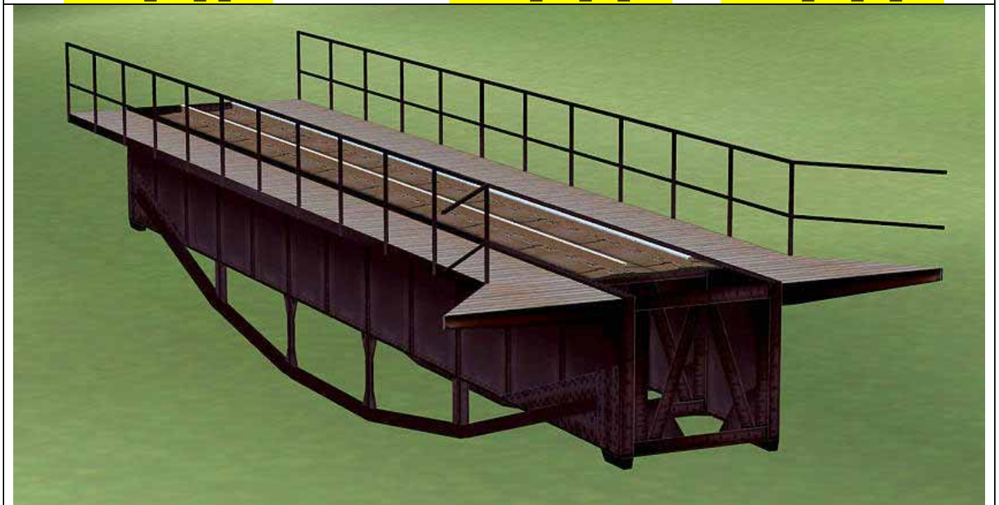
Gleisobjekt Nossen_Br2_03b_AF1 , Überbau, 16 m; Brückenelement im Flussbereich der Freiburger Mulde, als Übergangsstück zu Nossen_Br2_04a_AF1 mit sich verbreiterndem Laufsteg und 14 m – Gleisstück
