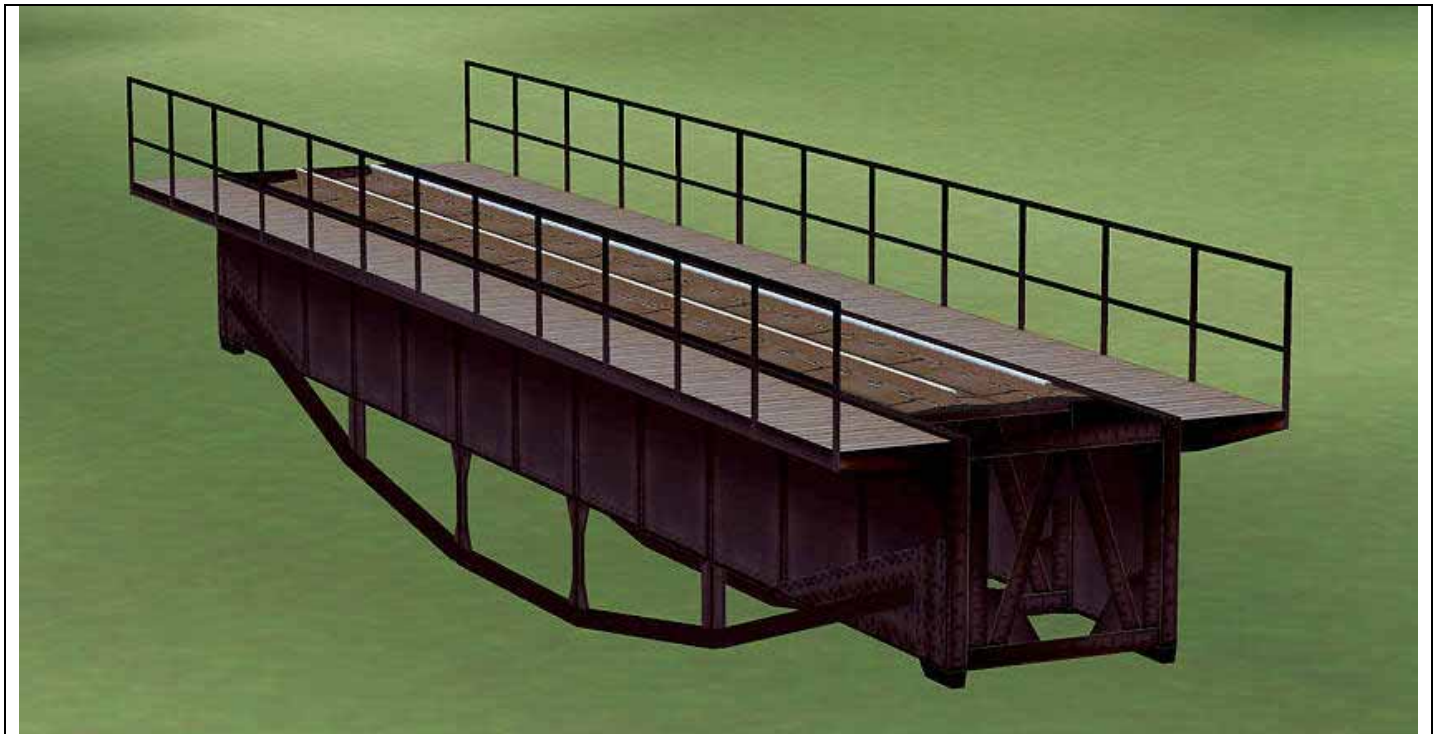
Gleisobjekt Nossen_Br2_03a_AF1 , Überbau, 16 m; Brückenelement im Flussbereich der Freiburger Mulde, mit 14 m - Gleisstück; über Nossen_Br2_5_AF1 kombinierbar mit Nossen_Br2_2b_AF1 und Nossen_Br2_3b_AF1
