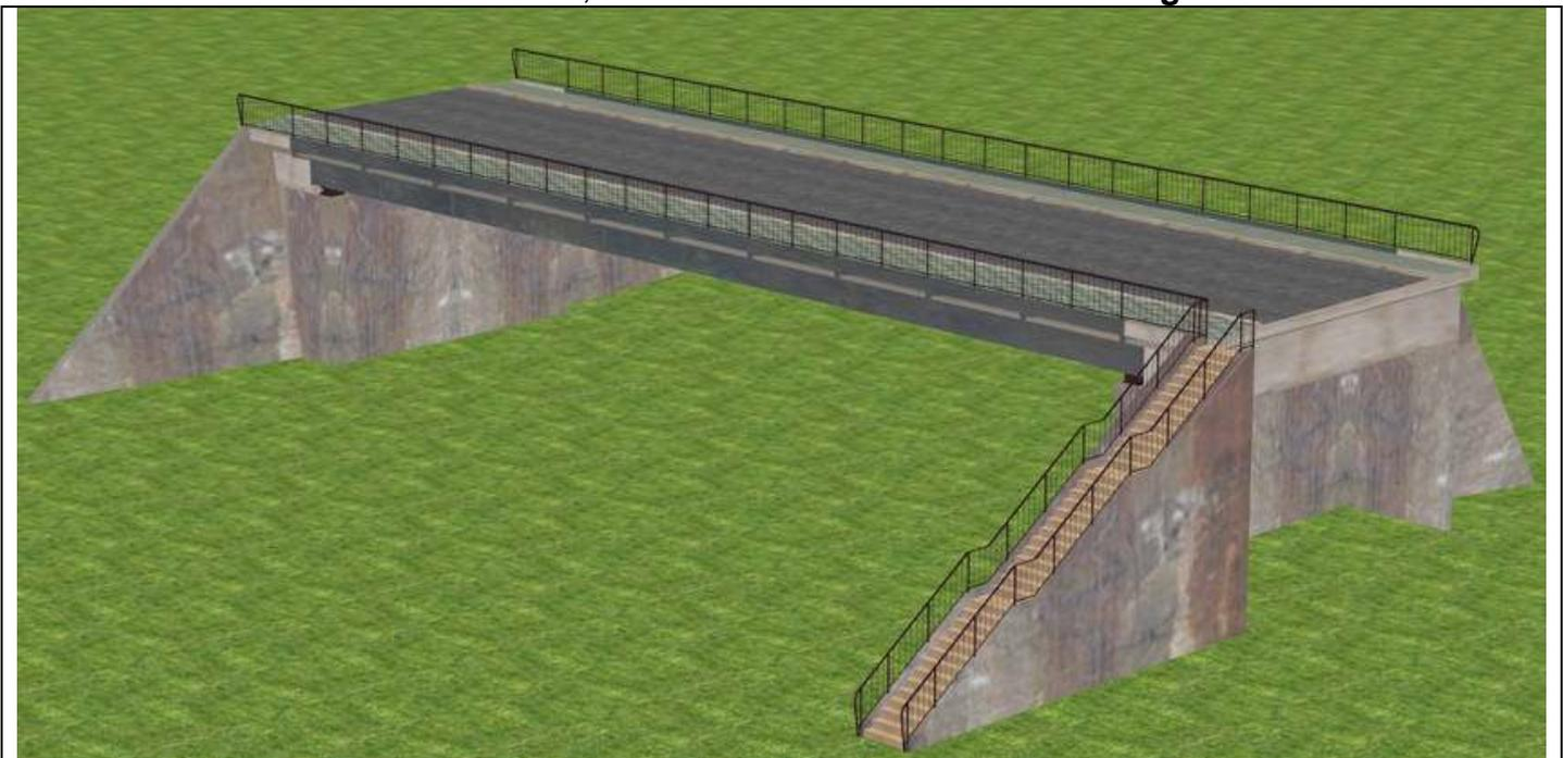
**Gleisobjekt Nossen\_Br4\_AF1**, Höhe 7 m; Straßenoberfläche (ohne Hilfsmittel) 5,75 m über Grund, mit Hilfsmittel **Nossen\_Br4\_Stufen\_AF1** bis 7,00 m; Straßenlänge 39,12 m; Lichte Weite 37,28 m
