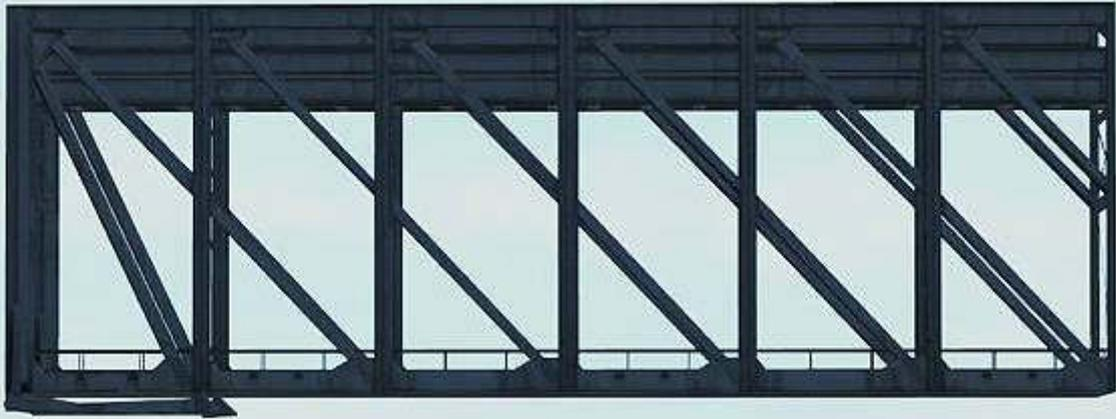
**Eglisau\_16\_AF1**, linkes Strom-Fachwerkelement, Länge 26,82 m, SO max. 51,3 m; links von **Eglisau\_15\_AF1**, rechts nach **Eglisau\_17\_AF1**
