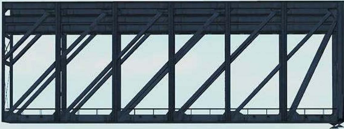
**Eglisau\_25\_AF1**, rechtes Strom-Fachwerkelement, Länge 26,82 m, Gleislänge 25,82 m, SO max. 51,3 m; links von **Eglisau\_17\_AF1**, rechts nach **Eglisau\_26\_AF1**
