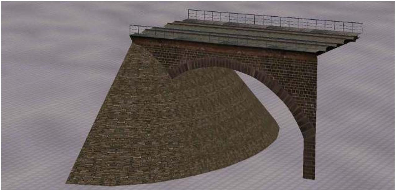
**Gleisobjekt Biehl\_2\_BrKpf\_R\_AF1:** 2gl Brückenkopf mit Steinböschung und rotem Gewölbebogen, Gleislänge 20 m, links und (um 180 ° gedreht) rechts verwendbar. Eingerichtet für Gleisstile mit Schotterbett.
