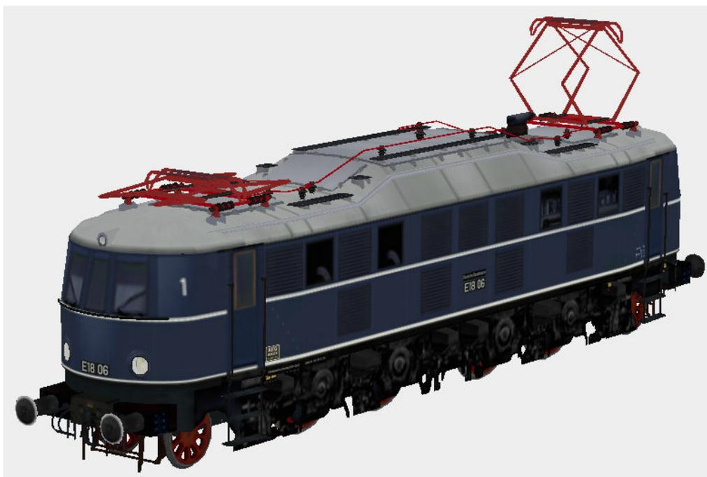
Ausführung der DB E18-06 mit DB-typischer kleinerer Frontschürze und Stromabnehmern SBS39/DBS54.
