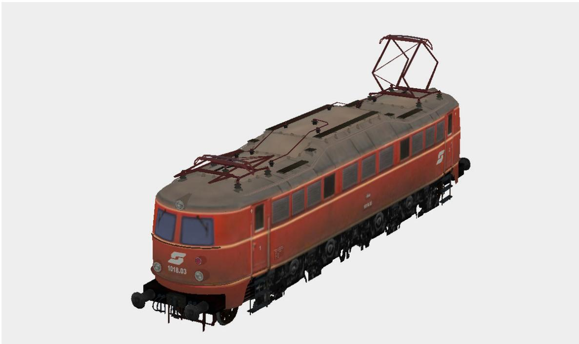
Ausführung der ÖBB E18`2 / 1018 mit ÖBB-typischen Frontfenstern, Lackierung in blutorange (RAL 2002) und Stromabnehmern WVSS54, Bauart V.
