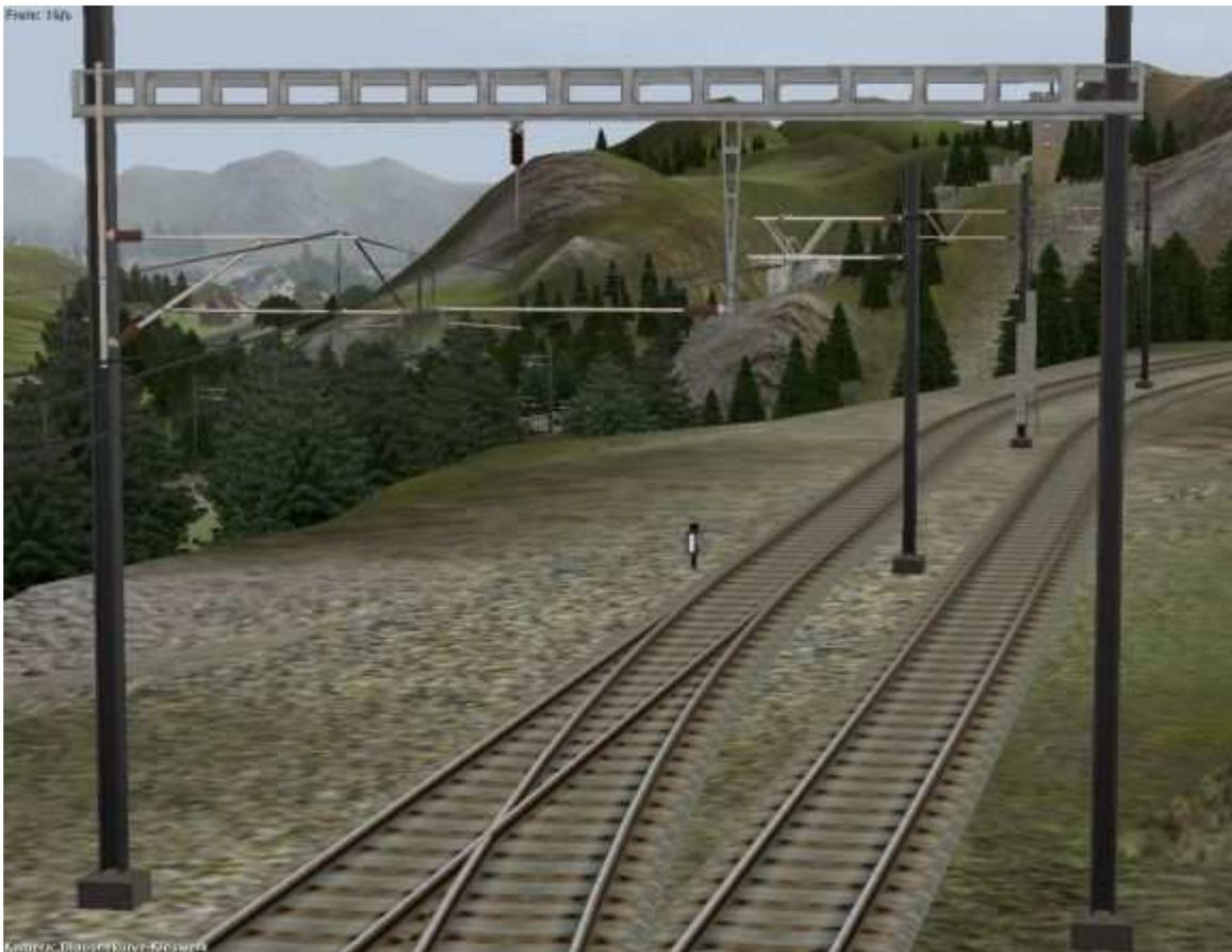
Unterschiedliche Ausleger am Quertragwerk Streckenmasten
