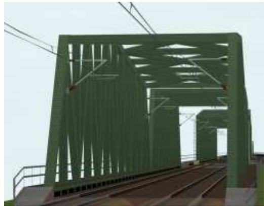
Halterung für die Oberleitung bei zweigleisigen Brücken
