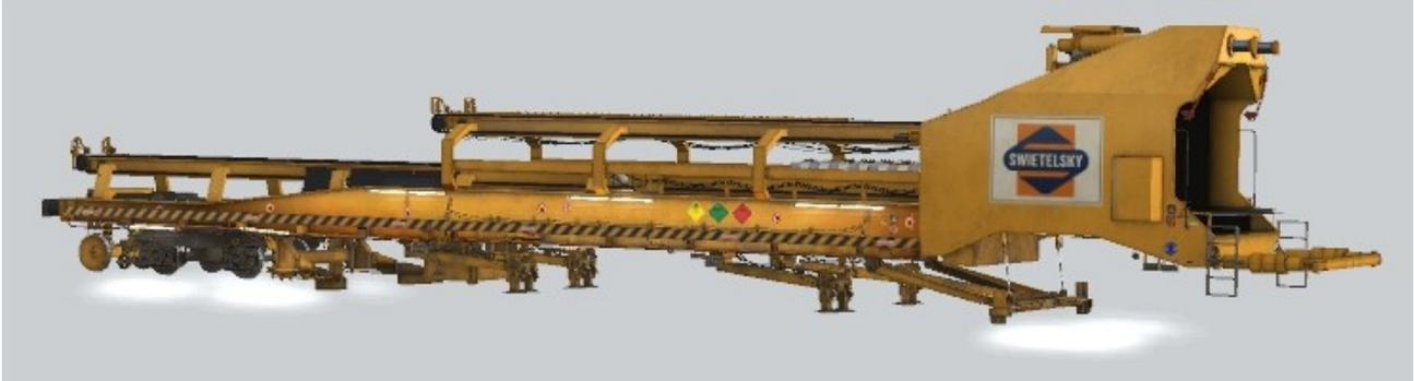
Mit diesem Set werden die Betonschwellen verlegt und die mit dem vorhergehenden Set vorbereiteten Schienen darauf gelegt.
