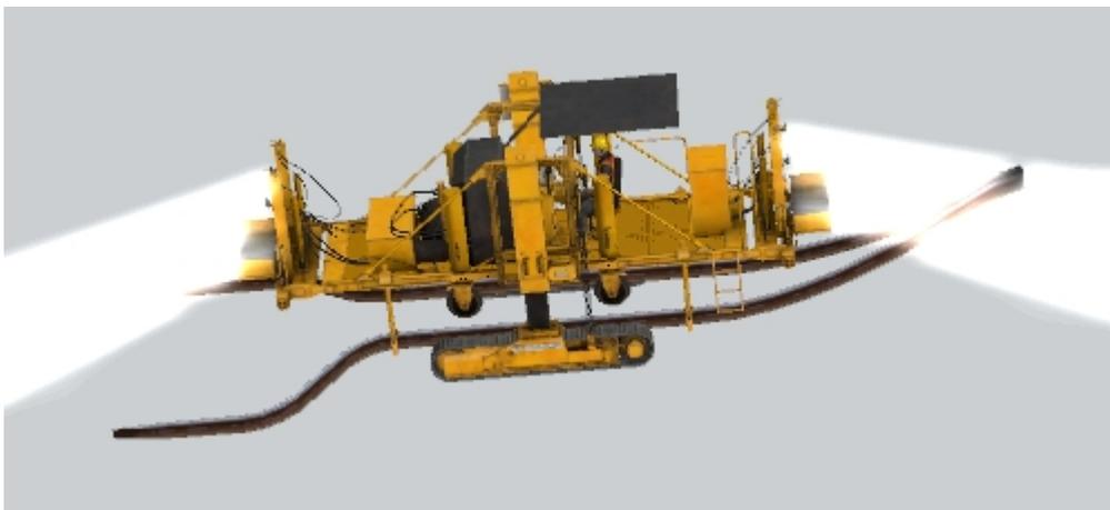
Diese beiden Fahrzeuge bilden ein Set zum Auseinanderziehen der Schienen an den Seiten des Bahndamms und bereiten die Arbeit für die nächste Maschine vor.
