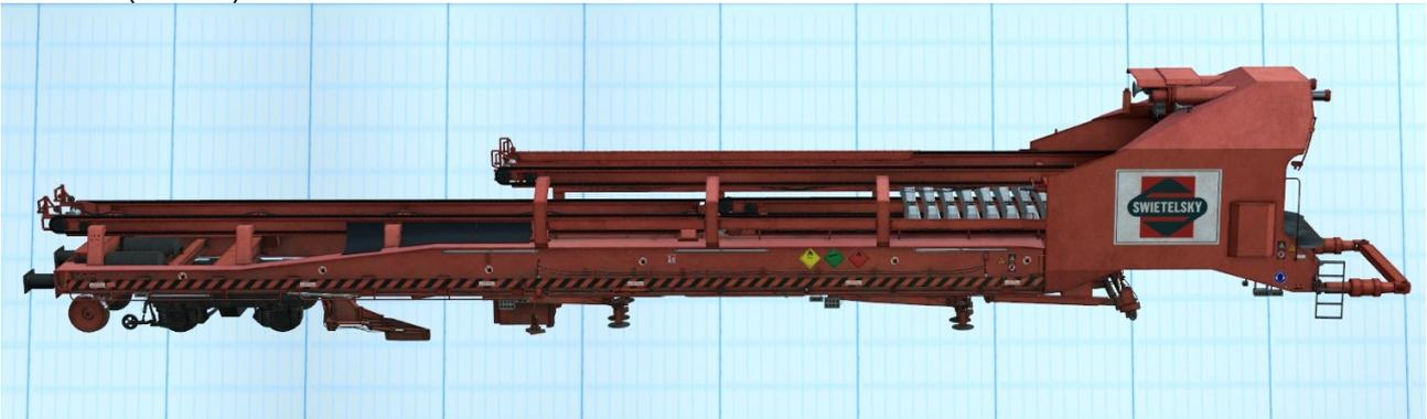
Mit diesem Set werden zunächst die Gleise dann die Schwellen aufgenommen, die Schwellen neu verlegt und die alten Gleise neben Gleisbett abgelegt
