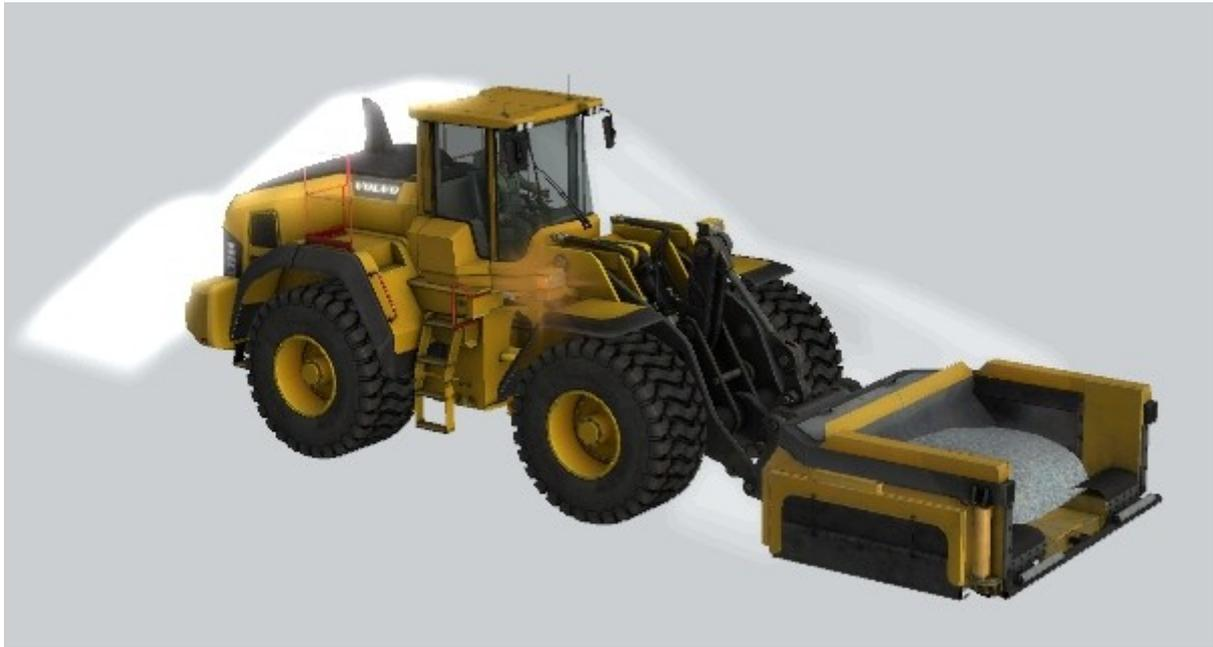
Diese beiden Fahrzeuge bilden eine Einheit, die auf der Strecke **TrKMchn\_Track1** verkehrt. Wie Sie sehen können, wird Schotter auf die Straße geschüttet und dann eingebnet.
