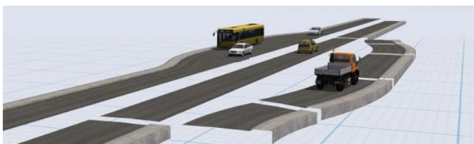
Typischer Aufbau einer Bushaltebucht
