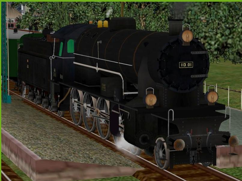
Das Modell BBÖ 113.01 gibt den Auslieferungszustand der Lokomotive nach der Umrüstung auf die Speisewasservorwärmung mittels Dabeg-Pumpe wieder.
