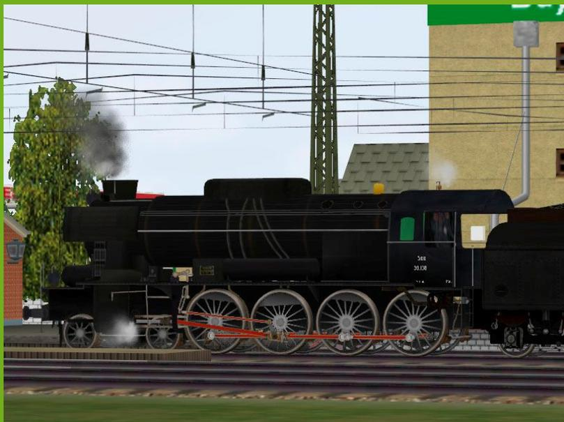
Das Modell ÖBB 33.138 stellt die Baureihe in der Zeit nach 1955 dar. Sie verfügt nun über eine Giesl-Blasrohranlage, Windleitbleche, einen Heihspeisewasservorwärmer in der Kuppel vor dem Dampfdom, sowie einen zusätzlichen Presslufttank.
