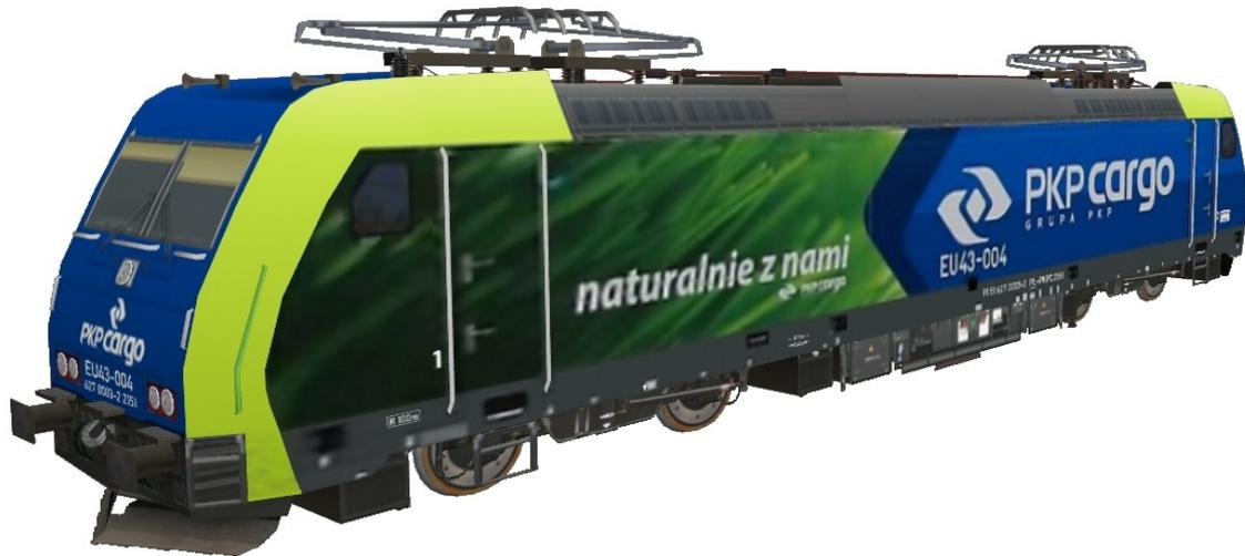
Die E-Lok PKP EU43-004 ist eine Mehrsystemlok für Gleich und Wechselstrom
