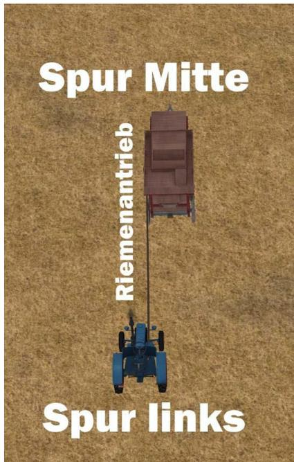
Der Riemenantrieb (im Lieferumfang der Dreschmaschine enthalten) dient der Kraftübertragung vom Riementrieb des Lanz Bulldogs auf das Dreschwerk, insbesondere die Dreschtrommel.
