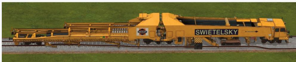
Mit diesem Set werden die Betonschwellen verlegt und die mit dem vorhergehenden Set vorbereiteten Schienen **darauf abgelegt**. Dieses Set kann vollständig als Block *Gleisbau3\_SUZ500.rss* geladen werden. Wenn das Gleis elektrifiziert werden soll, erscheint die Oberleitung über dem Gleis, nachdem das letzte Gleis vollständig durchfahren wurde. Eine solche Strecke ist anschließend für den Einsatz tauglich.
