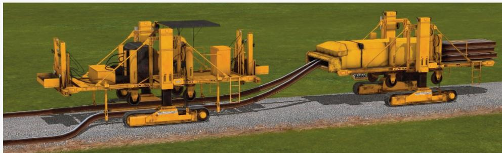
Diese beiden Fahrzeuge bilden ein Set zum Auseinanderziehen der Schienen an den Seiten des Bahndamms und bereiten die Arbeit für die nächste Maschine vor. Das fertige Set kann ebenfalls als Block geladen werden: „*Gleisbau2\_Schienen.rss*“.
