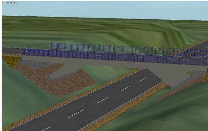
Überquerung Autobahn 2 Spurig - Kopf - Mittelteil 16m - Kopf - weiter wie oben
