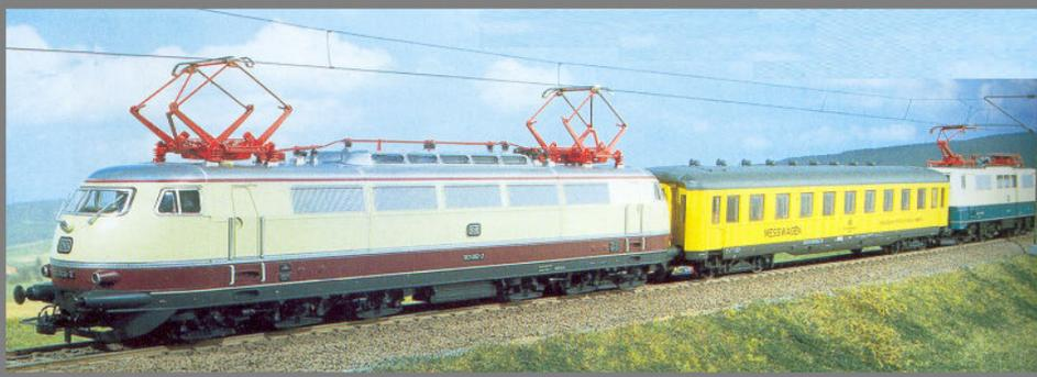
E- Lokomotiven bei einer messtechnischen Untersuchungsfahrt. Die Hintere Lokomotive dient als Bremslok.
