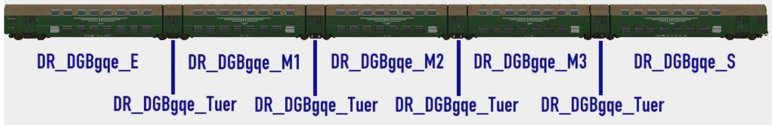
Beim Einsetzen ist auf die Richtige Position der Waggonteile zu achten. Der Gliederzug ist nicht zum Durchfahren von engen Gleisradien ausgelegt.
