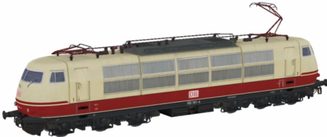
Elektrische Schnellfahrlokomotive der Baureihe 103.1 der DBAG in Epoche V mit Einholmstromabnehmer SBS65 mit Frontverkleidung. Beheimatet im Bw Hamburg Eidelstedt..
