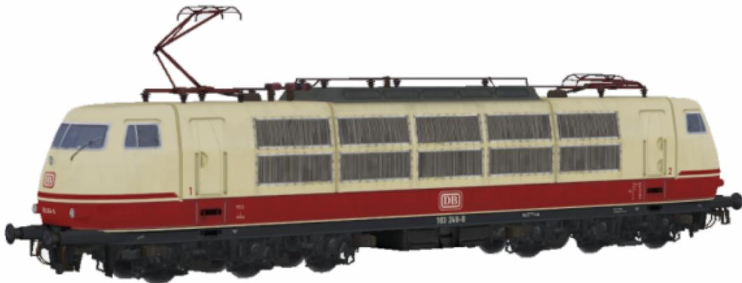
Elektrische Schnellfahrlokomotive der Baureihe 103.1 (fünftes Baulos) der DB in Epoche IV mit Einholmstromabnehmer SBS65 und Pufferverkleidung. Beheimatet im Bw Hamburg-Eidelstedt.
