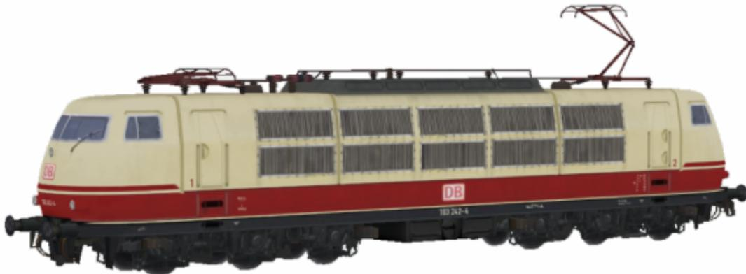
Elektrische Schnellfahrlokomotive der Baureihe 103.1 (fünftes Baulos) der DBAG in Epoche V mit Einholmstromabnehmer mit Pufferverkleidung. Beheimatet im Bw Hamburg Eidelstedt..
