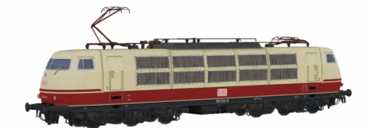
Elektrische Schnellfahrlokomotive der Baureihe 103.1 (fünftes Baulos) der DBAG in Epoche V mit Einholmstromabnehmer, ohne Frontverkleidung. Beheimatet im Bw Hamburg Eidelstedt.
