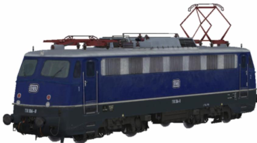
Mit Front- und Pufferverkleidung, seitliches Doppeldüsenlüfterband.
