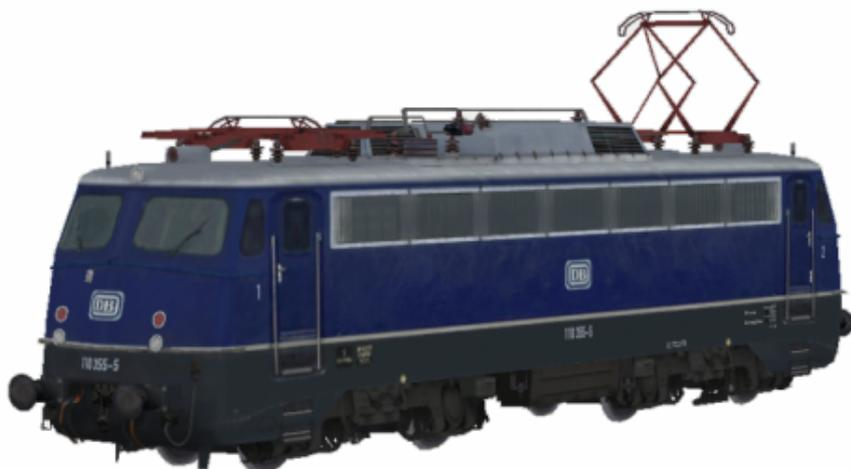
Mit Front- und ohne Pufferverkleidung, seitliches Klatte Lüfterband.
