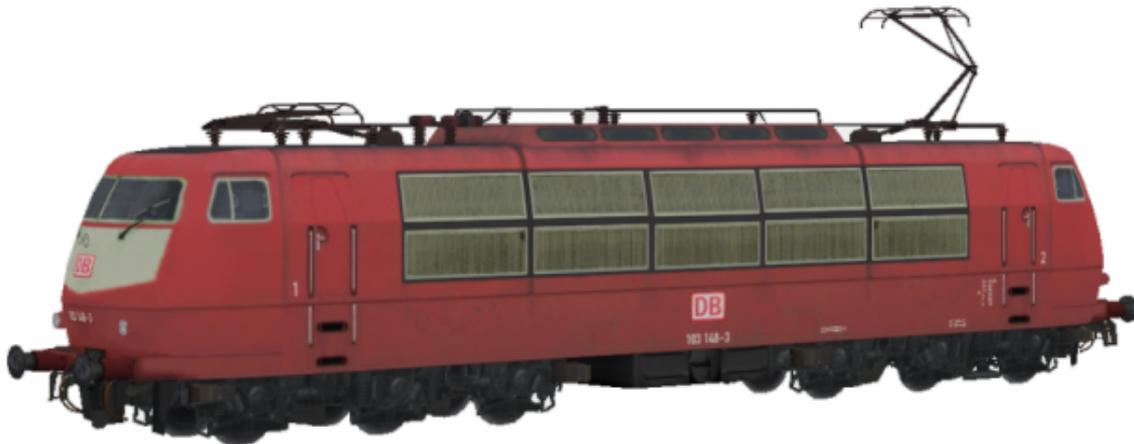
Elektrische Schnellfahrlokomotive der Baureihe 103.1 in orientroter Farbgebung der DBAG in Epoche V mit Einholmstromabnehmer SBS65 ohne Frontverkleidung. Beheimatet im Bw Frankfurt/M 1.
