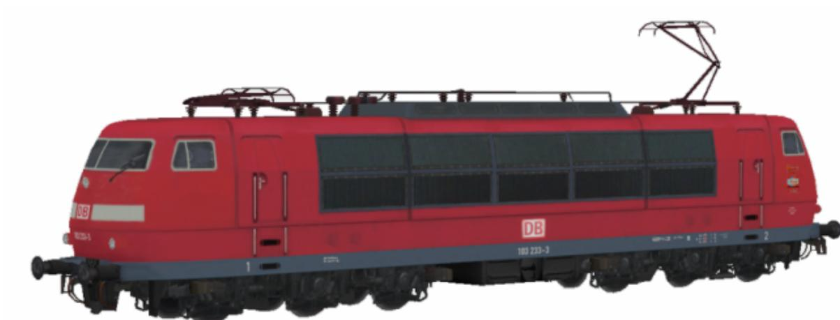
Elektrische Schnellfahrlokomotive der Baureihe 103.1 in verkehrsroter Farbgebung der DBAG in Epoche V mit Einholmstromabnehmer SBS65 ohne Frontverkleidung. Sponsorenanschriften der Firma Roco und des Werk Opladen.
