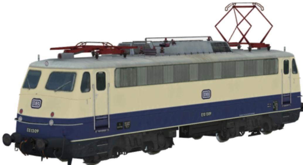
Mit Front- und Pufferverkleidung. Doppeldüsen-Lüfterband, mit Frontgriffen und Umlauf.
