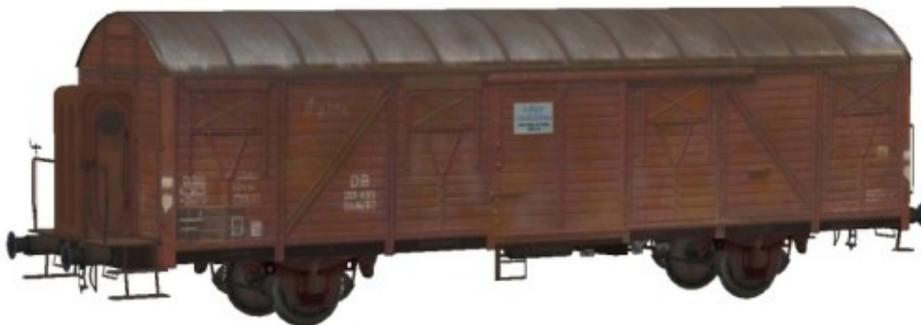
Gedeckter Neubau-Güterwagen der Gattung Glms50 mit Bremserbühne der DB in Epoche III.
