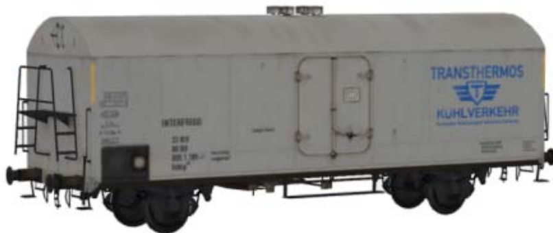
Eiskühlwagen der DB, vermietet an die Transthermos, Vmax 120km/h, Epoche IV
