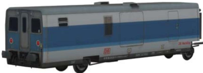
Endwagen 1 mit Dieselaggregat zur Stromversorgung des Zuges, Werkstattabteil, Gepäckabteil, Fahrradstellplätzen und Skihalterung.
