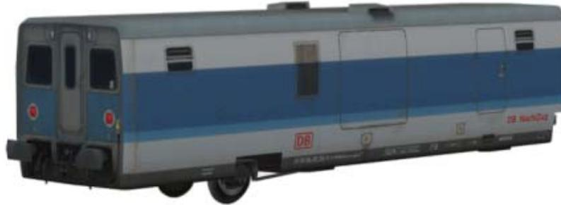
Endwagen 2 mit Dieselaggregat zur Stromversorgung des Zuges,
