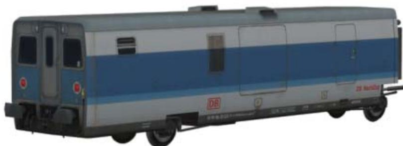
Endwagen 1 mit Diesellagregat zur Stromversorgung des Zuges, Werkstattabteil, Gepäckabteil, Fahrradstellplätzen und Skihalterung. Als einziger Wagen besitzt dieser zwei Radsätze.
