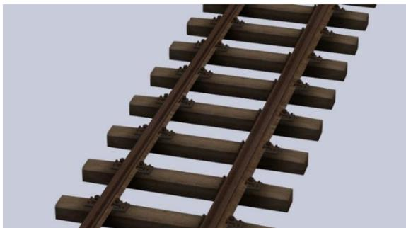
S49 1000mm Rille Rost Metallschwelle (CE1):
