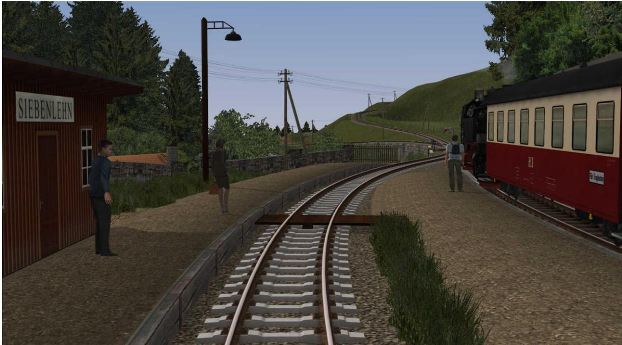
Bahnübergang eines Feldwegs mit Verwendung von Rillenschienen:
