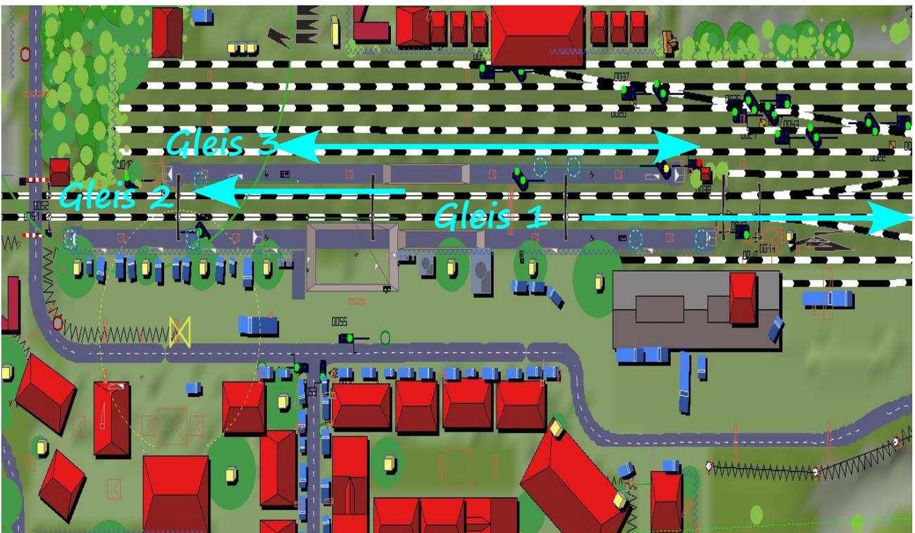
Das bedeutet, dass jedes Gleis der Hauptstrecke nur in eine Richtung befahren werden darf (soll/kann).
