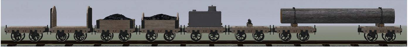
In England wurden bereits Mitte des 19. Jahrhunderts Wagen für Eisenbahnen der Spurweite 1 Fuss 11 1/2 Inch (entspricht in etwa der 600mm Spurweite) gebaut. Die kleinen 2-Achser hatten hölzerne Fahrwerke mit gußeisernen Achslagern, Achsen und Speichenrädern und besaßen bereits eine Art Mittelpuffer.
