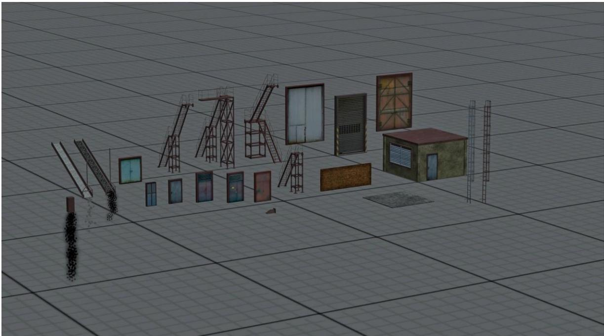
Die Modelle zur Ausgestaltung der Zechenanlage, wie etwa einzelne Türen, Tore, Fenster, Wände, Treppen, Leitern, Lampen, Kohlschütten usw. sind frei positionierbare und skalierbare Vorsatzimmobilien vor der eigentlichen Fassade. Zwar stehen die Teile dadurch zwangsläufig etwas vor der Fassade, aber sie sind damit eben auch nach Belieben zu positionieren.
