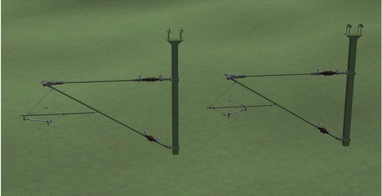
In dem Bild ist links ein Halter mit einem langen Ausleger und rechts mit einem kurzen Ausleger zu erkennen. Hier wird, wie in den Modellsets zuvor, der lange Ausleger in der Zickzack-Einstellung vom Halter wegbewegt, der kurze zum Halter hin.
