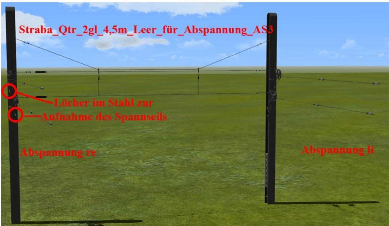
Dieses hier gezeigte Modell hat auf beiden Seiten 2 Löcher im Stahlprofil, damit in beide Richtungen abgespannt werden kann, ohne den Mast drehen zu müssen oder falls jemandem eine Bausituation einfällt, die eine Abspannung in beiden Richtungen nötig macht (also jeweils eine Richtung pro Seite, niemals beide Richtungen auf einer Seite, da sich die Spannweite dann gegenseitig überlappen und behindern).
