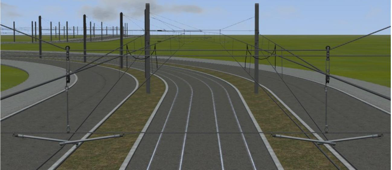
In der Realität wird dieses Problem durch unterschiedliche Höhen der Oberleitung gelöst, leider ist das in EEP so nicht darstellbar. Da aber die Fahrdrähtalter auf Zug gebaut sind, muss einer dieser Fahrdrähtalter etwas eingedreht werden, damit sich beide nicht überlappen.
