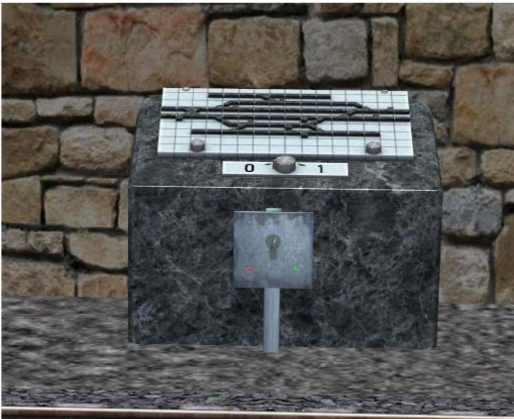
Die Kameras „Rangiermodus\_W\_O“ und „Rangiermodus\_O\_W“ zeigen jeweils auf ein GBS-Modell. Der davor stehende Schlüsselschalter bewirkt eine Umschaltung zwischen manuellem (grün) und automatischem (rot) Rangieren.
