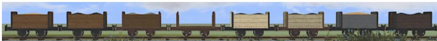
Bei fast allen Feldbahnen wurden Fahrzeuge in den eigenen Werkstätten gebaut oder umgebaut. So wurde viele Lorenfahrwerke als einfache Flachwagen oder auch Kastenwagen weiterverwendet. Oft waren die Kastenaufbauten fest zusammen gezimmert, aber manchmal waren die Seitenwände auch einsteckbar, was zu einer deutlich flexibleren Nutzung führte.
