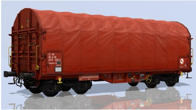
Der Shimmns-tu720 ist ein Drehgestell-Flachwagen in Sonderbauart mit verschiebbarem Planenverdeck und Lademuellen für Coil- und Spaltbandtransporte.
