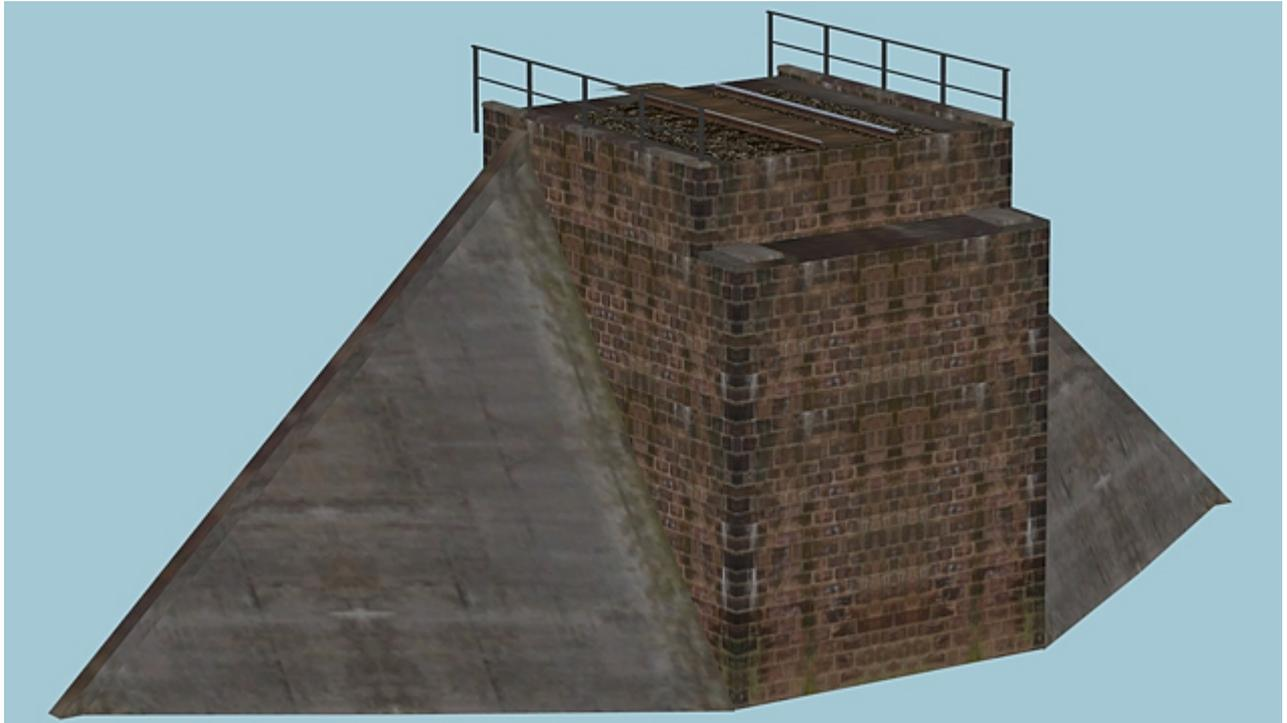
BrKpf **R\_BrKpf\_D\_F\_li\_AF1**; erhältlich in den Ausführungen links und rechts, mit und ohne Betonausbesserung, jeweils mit und ohne Stützmauer.
