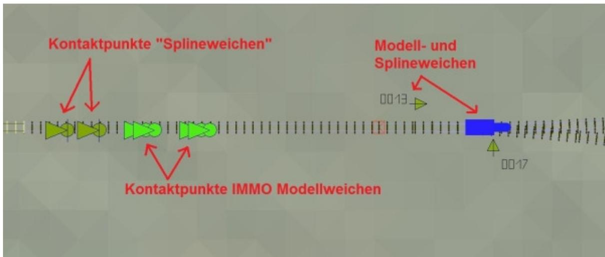
Das Bild zeigt nur ein einfaches Anwendungsbeispiel, zur Verdeutlichung der ungefähren Lage der entsprechenden Kontaktpunkte. (aus der Demo - Anlage) Bei komplizierteren "Weichenschaltungen" etwa mit "Steuerkreisen" muss man die entsprechenden Lagen der Kontaktpunkte durch Versuche ermitteln.
