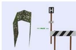
Solange das Signal auf Halt steht, fährt für einen in den Schattenbahnhof einfahrenden Zug kein neuer Zug aus. Auf diese Weise können Sie die Anlage auch komplett „leerfahren“.
