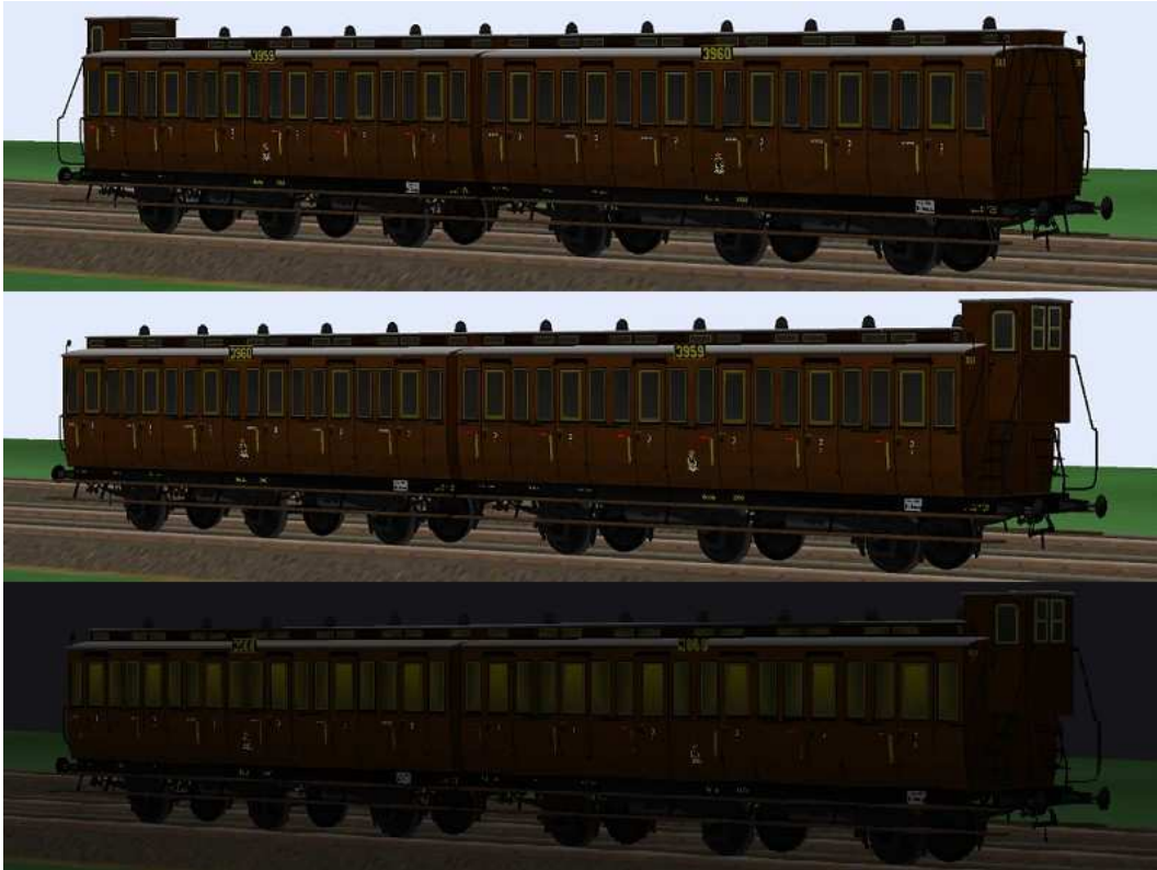
kurzgekuppelte 3.Klasse-Wagen mit den Nummern Berlin 3959/3960, mit Bremserhaus und 6,5 m Radstand.
