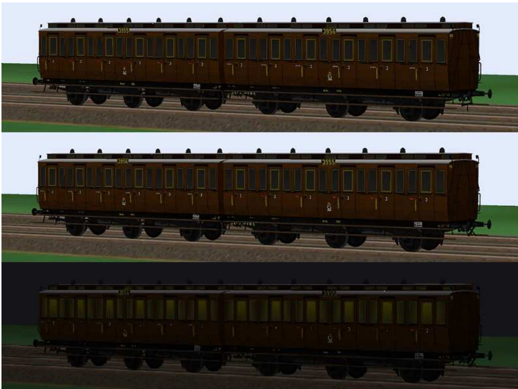
kurzgekuppelte 3.Klasse-Wagen mit den Nummern Berlin 3955/3956, ohne Bremserhaus und 6,5 m Radstand.
