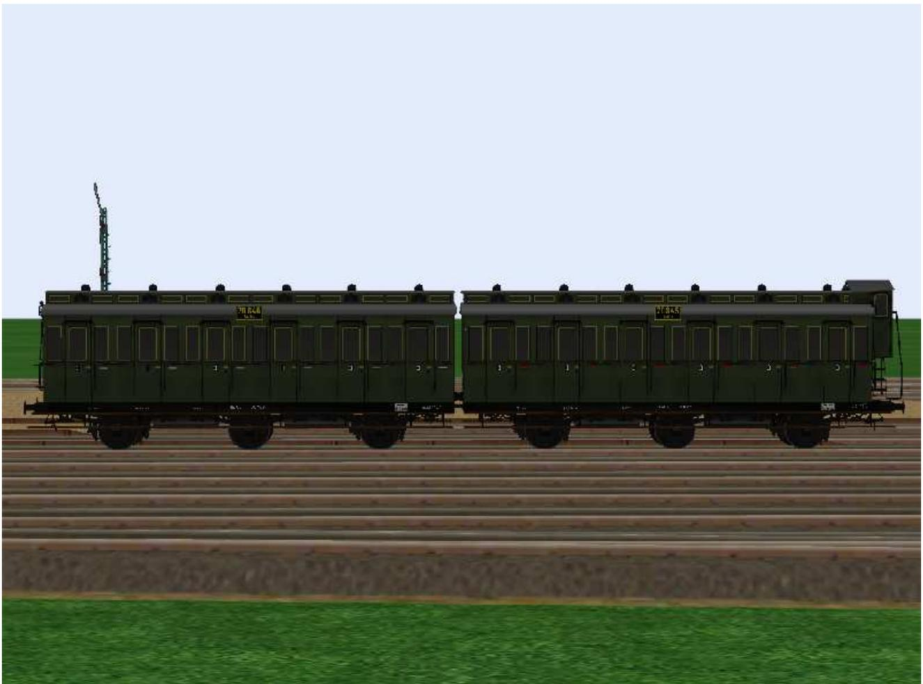
kurzgekuppelte 3.Klasse-Wagen mit den Nummern Berlin 70 845/70 846, mit/ohne Bremserhaus und 6,5 m Radstand.
