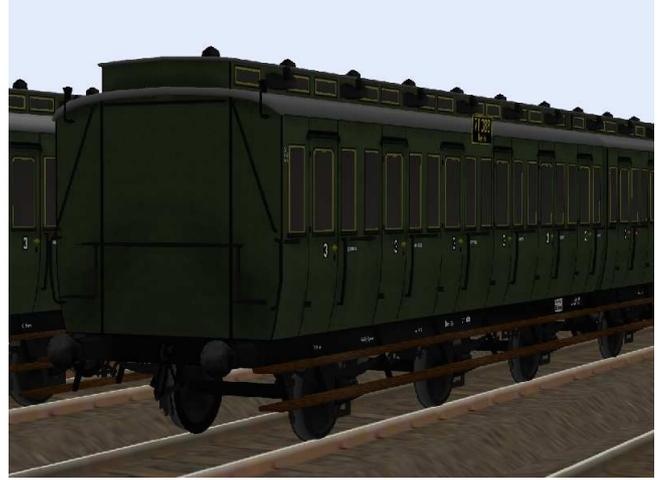
kurzgekuppelte 3.Klasse-Wagen mit den Nummern Berlin 71 387/71 388, mit/ohne Bremserhaus und 6,5 m Radstand.
