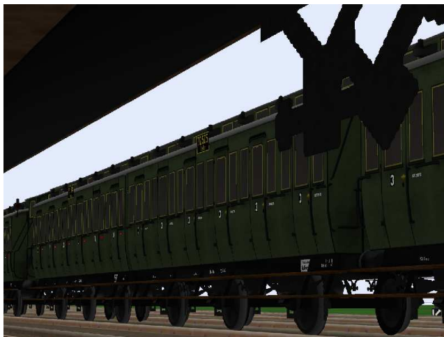
kurzgekuppelte 3.Klasse-Wagen mit den Nummern Berlin 72 504/72 505, mit/ohne Bremserhaus und 6,5 m Radstand.
