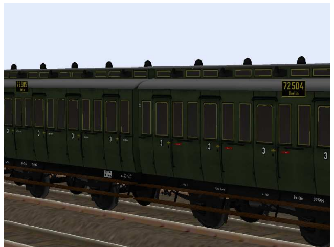
kurzgekuppelte 3.Klasse-Wagen mit den Nummern Berlin 72 504/72 505, mit/ohne Bremserhaus und 6,5 m Radstand.
