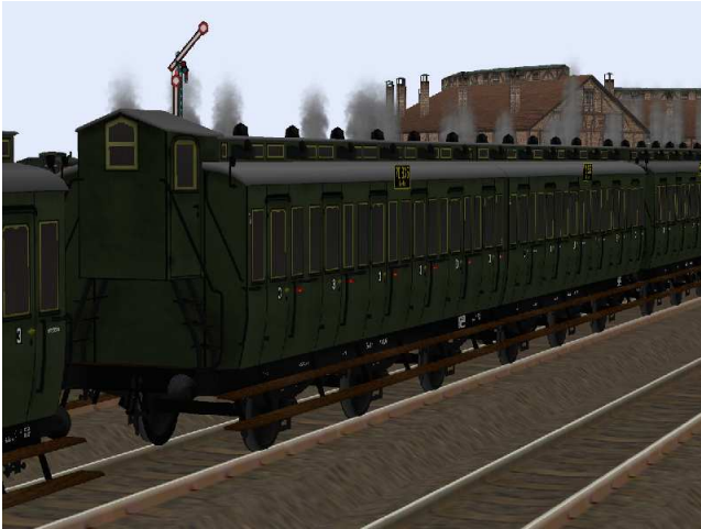
kurzgekuppelte 3.Klasse-Wagen mit den Nummern Berlin 70 935/70 936, mit/ohne Bremserhaus und 6,5 m Radstand.
