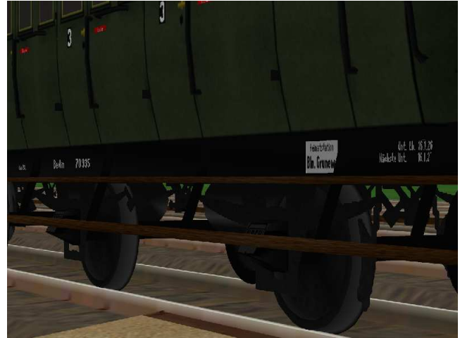
kurzgekuppelte 3.Klasse-Wagen mit den Nummern Berlin 70 935/70 936, mit/ohne Bremserhaus und 6,5 m Radstand.
