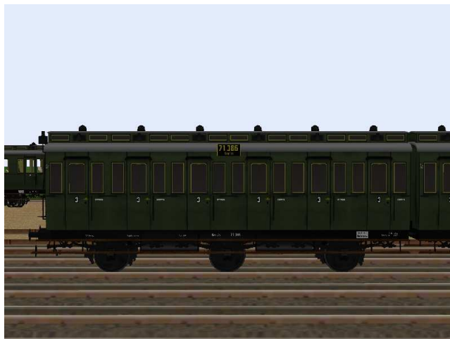
kurzgekuppelte 3.Klasse-Wagen mit den Nummern Berlin 71 385/71 386, mit/ohne Bremserhaus und 6,5 m Radstand.
