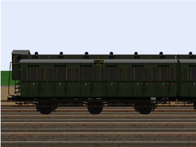
kurzgekuppelte 3.Klasse-Wagen mit den Nummern Berlin 71 240/71 241, mit/ohne Bremserhaus und 6,5 m Radstand.
