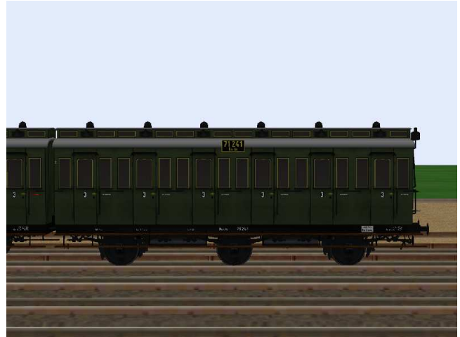
kurzgekuppelte 3.Klasse-Wagen mit den Nummern Berlin 71 240/71 241, mit/ohne Bremserhaus und 6,5 m Radstand.
