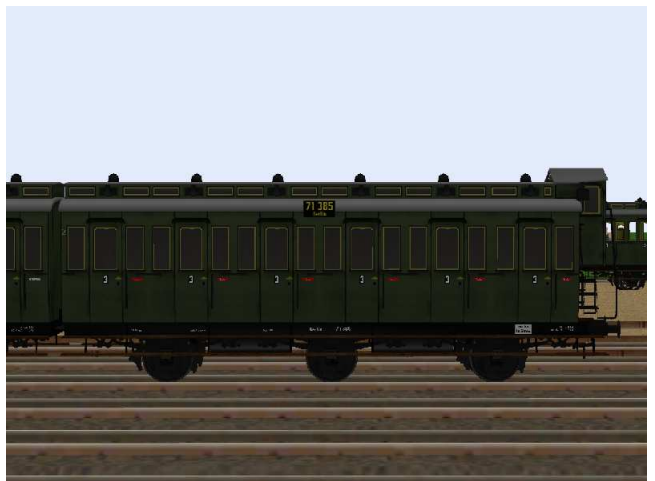
kurzgekuppelte 3.Klasse-Wagen mit den Nummern Berlin 71 385/71 386, mit/ohne Bremserhaus und 6,5 m Radstand.
