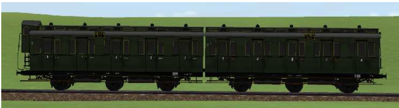
kurzgekuppelte 2.Klasse-Wagen mit den Nummern Berlin 50 725 / 50 726, mit/ohne Bremserhaus und 6,5 m Radstand.
