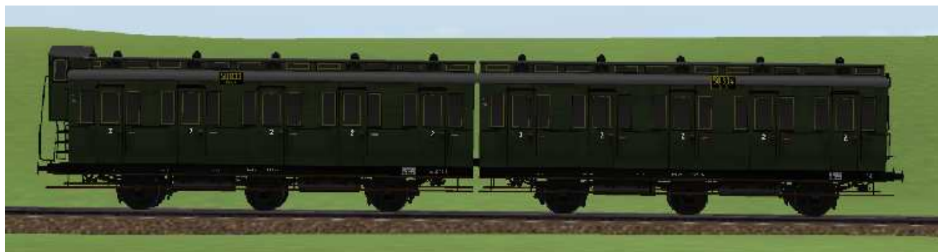
kurzgekuppelte 2.Klasse-Wagen mit den Nummern Berlin 50 833 / 50 834, mit/ohne Bremserhaus und 6,5 m Radstand.
