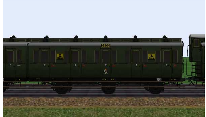
kurzgekuppelte 2.Klasse-Wagen mit den Nummern Berlin 3631/3632, mit/ohne Bremserhaus und 6,5 m Radstand.
