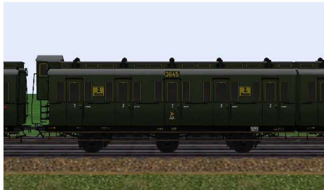
kurzgekuppelte 2.Klasse-Wagen mit den Nummern Berlin 3645/3646, mit/ohne Bremserhaus und 6,5 m Radstand.
