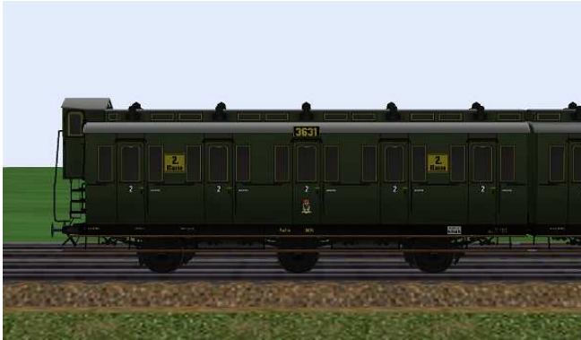
kurzgekuppelte 2.Klasse-Wagen mit den Nummern Berlin 3631/3632, mit/ohne Bremserhaus und 6,5 m Radstand.
