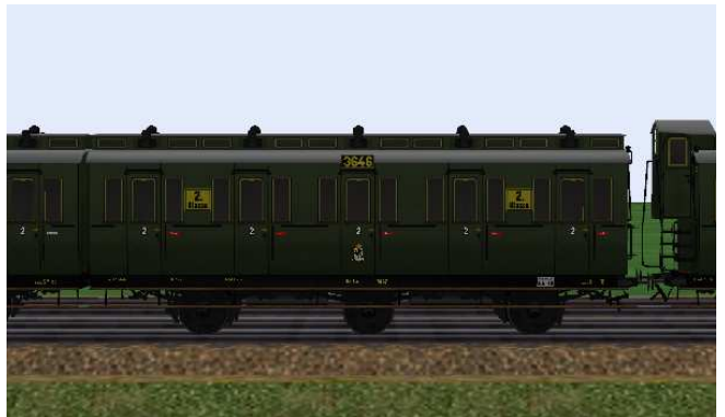
kurzgekuppelte 2.Klasse-Wagen mit den Nummern Berlin 3645/3646, mit/ohne Bremserhaus und 6,5 m Radstand.
