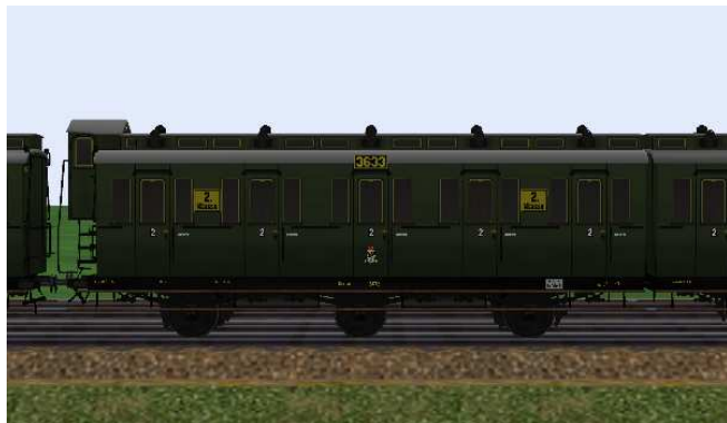
kurzgekuppelte 2.Klasse-Wagen mit den Nummern Berlin 3633/3634, mit/ohne Bremserhaus und 6,5 m Radstand.
