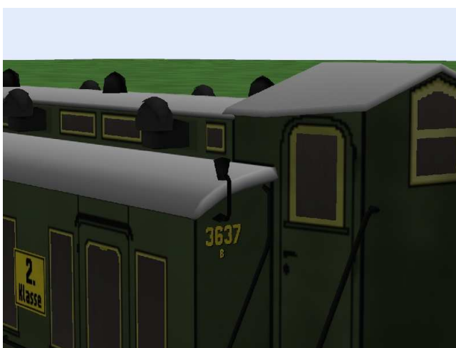
Wagen mit Lüftern Bauart Glove Berlin 3637
