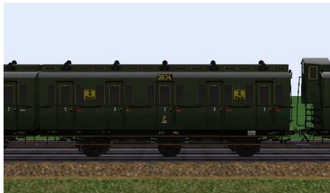
kurzgekuppelte 2.Klasse-Wagen mit den Nummern Berlin 3633/3634, mit/ohne Bremserhaus und 6,5 m Radstand.
