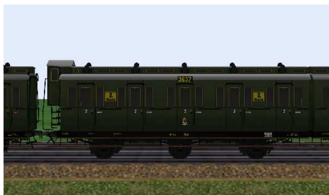
kurzgekuppelte 2.Klasse-Wagen mit den Nummern Berlin 3637/3638, mit/ohne Bremserhaus und 6,5 m Radstand.
