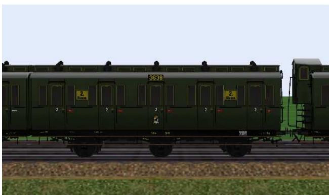
kurzgekuppelte 2.Klasse-Wagen mit den Nummern Berlin 3637/3638, mit/ohne Bremserhaus und 6,5 m Radstand.
