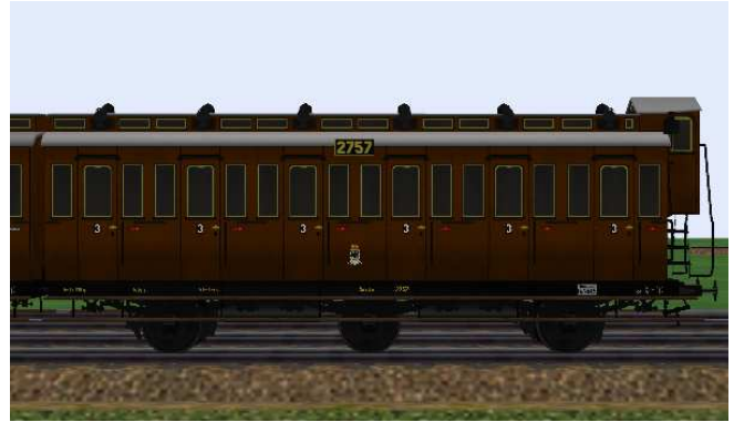
kurzgekuppelte 3.Klasse-Wagen mit den Nummern Berlin 2758/2757, mit/ohne Bremserhaus und 6,5 m Radstand.
