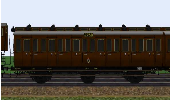
kurzgekuppelte 3.Klasse-Wagen mit den Nummern Berlin 2758/2757, mit/ohne Bremserhaus und 6,5 m Radstand.
