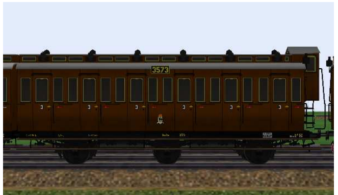
kurzgekuppelte 3.Klasse-Wagen mit den Nummern Berlin 3573/3574, mit/ohne Bremserhaus und 6,5 m Radstand.
