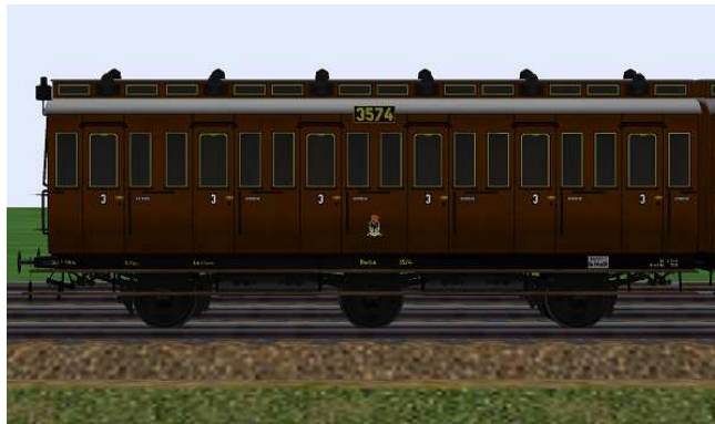
kurzgekuppelte 3.Klasse-Wagen mit den Nummern Berlin 3573/3574, mit/ohne Bremserhaus und 6,5 m Radstand.
